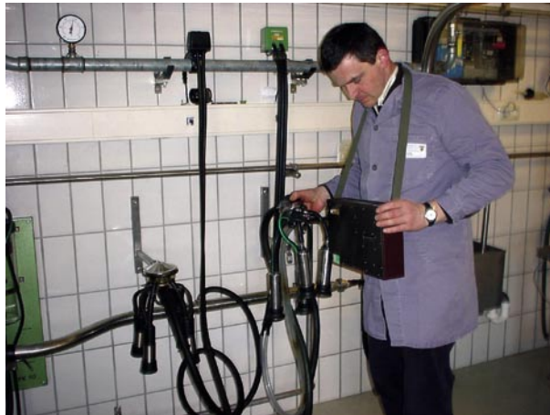
Pulsatorprüfung von geschulten Technikern durchführen lassen
